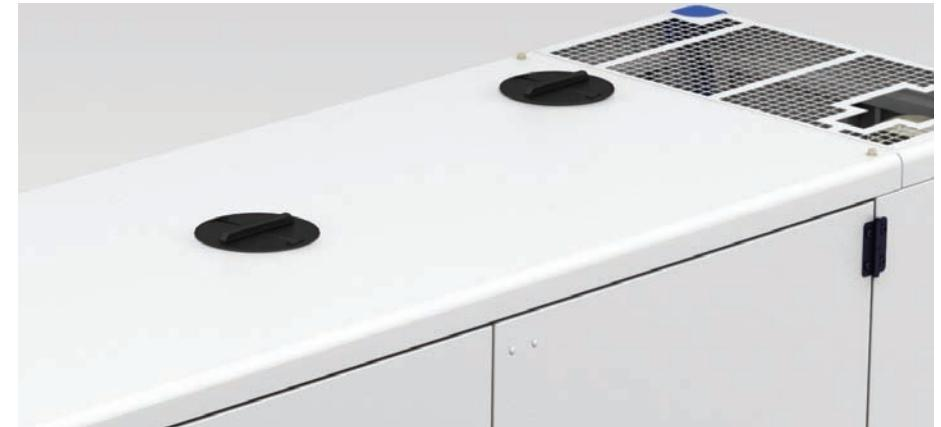
На прочной крыше расположены невыступающие защитные колпачки с компрессионными уплотнениями, открывающие доступ к заливной горловине радиатора и дополнительной точке подъема и перетягивания, одновременно обеспечивая защиту от попадания воды.
