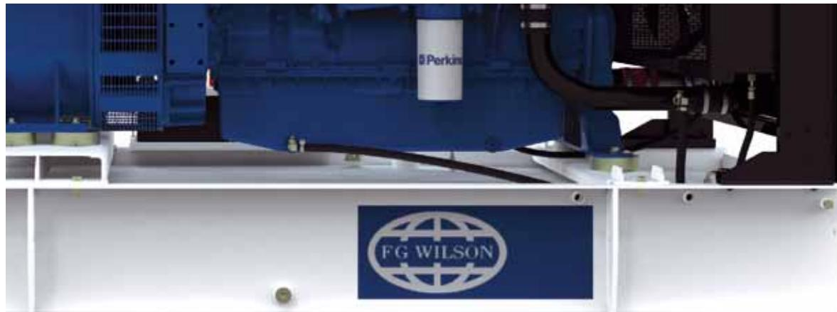
Теперь топливный бак оснащен усиленной скошенной верхней пластиной, обеспечивающей сток жидкости, которая может быть пролита на него. А благодаря скошенной нижней пластине и пробке сливного отверстия с пазом опорожнение топливного бака теперь осуществляется более эффективно. Топливный бак рассчитан на 8 часов работы при полной нагрузке в основном режиме.
