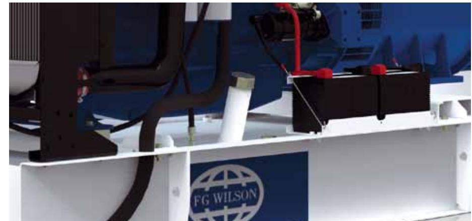
Заливная горловина топливного бака шириной 3 дюйма облегчает дозаправку, а клапаны для слива масла и охлаждающей жидкости обеспечивают оптимальный доступ для технического обслуживания. На опорной раме в стандартной комплектации предусмотрены точки для подъема и перетягивания, которые облегчают транспортировку и снижают риск повреждения при подъеме вилочным погрузчиком и других перемещениях.
