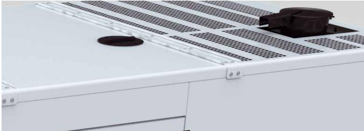
Крыша усиlena за счет прочных соединений внахлест, в которых используются уплотнения из бутилкаучука; благодаря этому достигается превосходная защита от попадания воды внутрь кожуха даже в самых тяжелых условиях эксплуатации. Благодаря закругленным краям прочная конструкция кожуха выглядит эстетично. Доступ к радиатору осуществляется через установленный заподлицо колпак защиты от дождя с компрессионным уплотнением – еще одно средство защиты от попадания воды.
