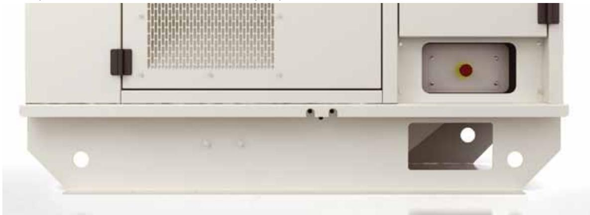
Длина опорной рамы, на которой расположены точки для перетягивания, превышает длину кожуха, за счет чего достигается дополнительная защита от повреждений во время транспортировки и установки.
