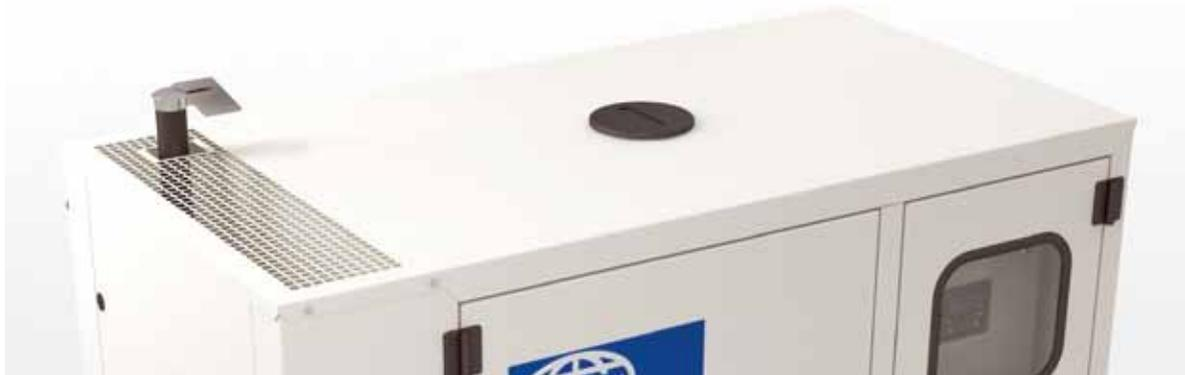
Прочная цельная крыша оснащена устанавливаемым заподлицо колпаком с компрессионным уплотнением, предоставляющим доступ к единой точке подъема и одновременно обеспечивающим превосходную защиту от попадания воды внутрь кожуха. Благодаря расположенной внутри кожуха системе глушения выхлопа наши генераторные установки демонстрируют лучшие на рынке шумоподавляющие характеристики, что благоприятно сказывается на безопасности оператора.
