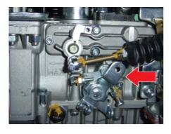
Для многорежимного двигателя установите акселератор на максимальные обороты. В генераторном исполнении обороты зафиксированы на значениях 3090-3150 об/мин.
