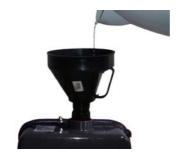
При низких окружающих температурах (-10°C) добавляйте в топливо специальные присадки, предотвращающие загустевание дизельного топлива.
