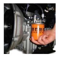
Снимите топливный фильтр и замените его новым
