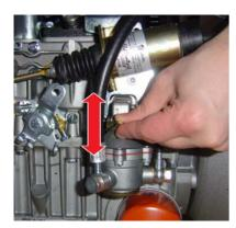
Прокачивайте топливную систему при помощи подкачивающего насоса, пока не будет выходить чистое топливо без пузырьков.
