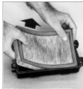
Аккуратно постучите фильтрующим элементом о жесткую поверхность, чтобы извлечь из него накопившиеся загрязнения. Не применяйте сжатый воздух для очистки бумажного фильтрующего элемента.
