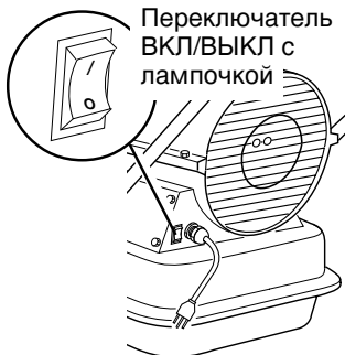
Рис. 6. Кнопка повторного зажигания для нагревателей мощностью 30 и 43 кВт
