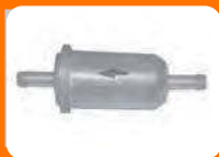
Рис. 32 Стрелка направления прохождения топлива
