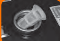
Рис. 29 Топливный фильтр грубой очистки генератора в шумозащищенном кожухе
