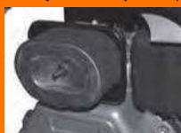
Рис. 8 Элемент воздушного фильтра
