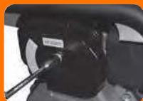
Рис. 8 Винт крышки воздушного фильтра
