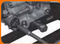
Рис. 23 Винт масляного фильтра
