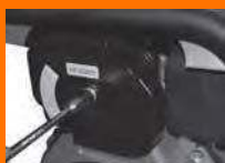
Рис. 7 Винт крышки воздушного фильтра
