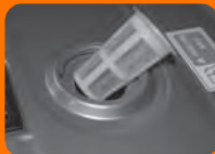
Рис. 30 Топливный фильтр грубой очистки генератора открытого типа
