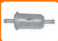
Рис. 32 Стрелка направления прохождения топлива
