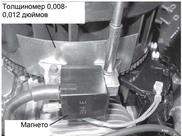
Рисунок 25. Регулировка воздушного зазора магнето (ротора) зажигания
