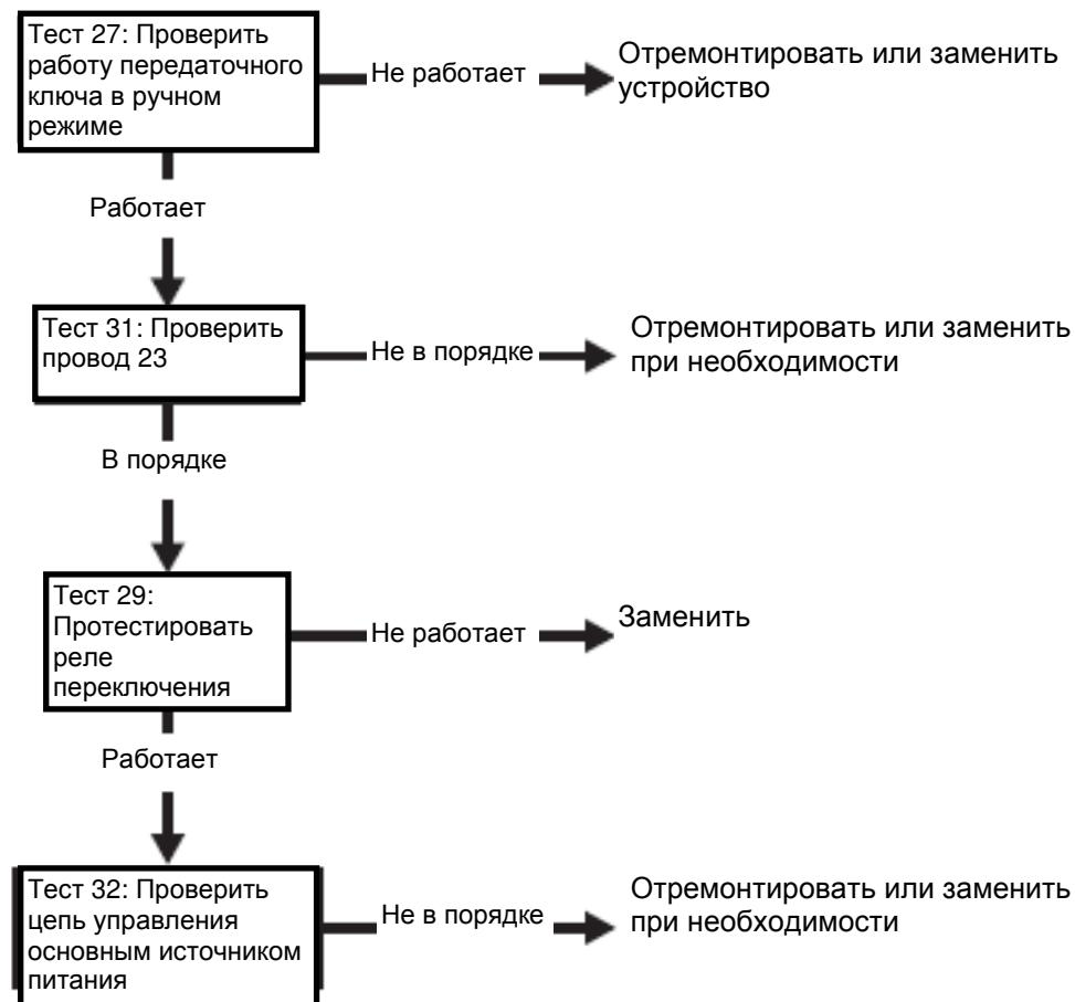
**Проблема 9: Перегорели предохранители F1 и F2**
