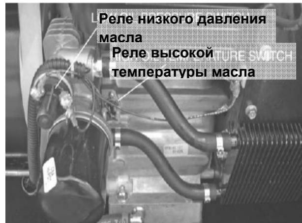
**Рисунок 33. Реле низкого давления масла**
