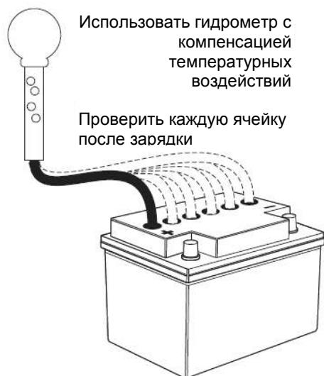
*Рисунок 4. Применение аккумуляторного гидрометра*
