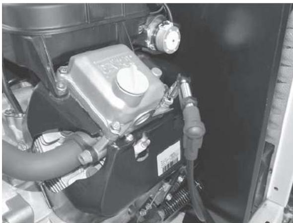
Рисунок 20. Проверка наличия искры зажигания
