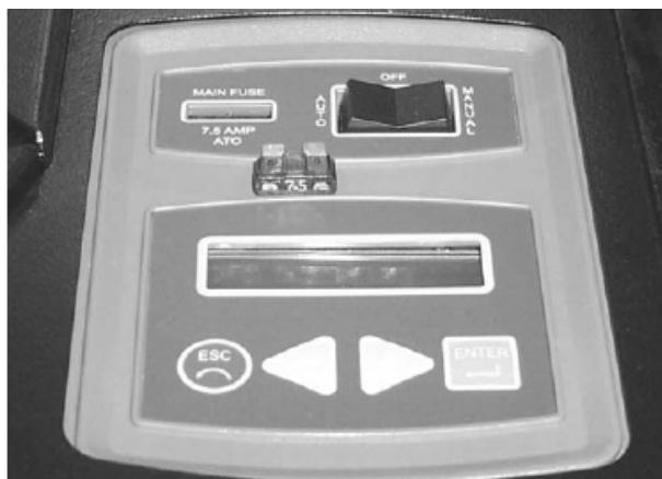
Рисунок 1. Снять предохранитель 7,5 А
