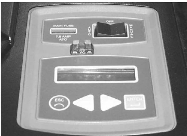
Рисунок 22. Снять предохранитель 7,5A
